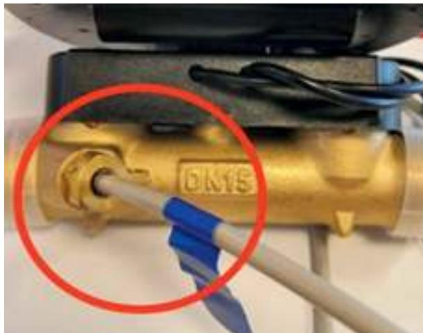
5. При извлечении изначально закрученного термодатчика может сместиться резиновое уплотнительное кольцо. Его нужно вернуть в посадочное место тонким (но не острым) инструментом, или использовать для этого кончик термодатчика.
