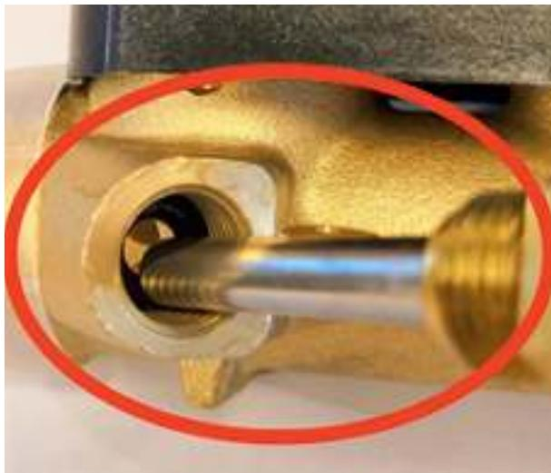
6. Затем нужно увлажнить термодатчик и установить в расходомер, попав при этом в резиновое уплотнительное кольцо.
