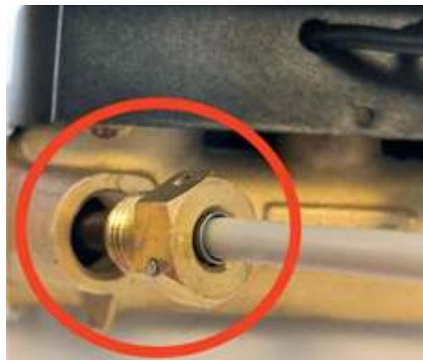
7. Закрутите термодатчик руками. Затем слегка затяните с усилием  $12 \pm 2$  Н·м
